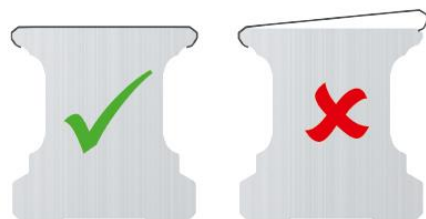
5.45. ábra: Helyesen és helytelenül felszerelt borítószalag
